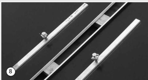
8. Avvitare le viti esagonali M 8 35 mm (con spessore profilato a U e sopra 2 dadi M 8 con rondelle per il bloccaggio) nei profilati in AL provvisti di filetto M 8.
